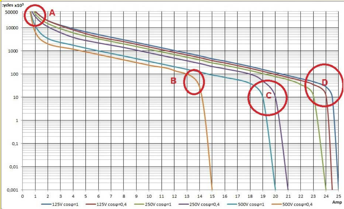
Durée de vie moyenne du contact électrique d'un thermostat 15A 250V, 300.000 cycles
